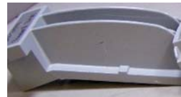
Industriestandardprodukt nach 3000 Stunden Salzsprühetest (ASTM B117)
