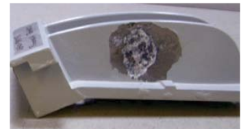
Industriestandardprodukt nach 3000 Stunden Salzsprühetest (ASTM B117)
